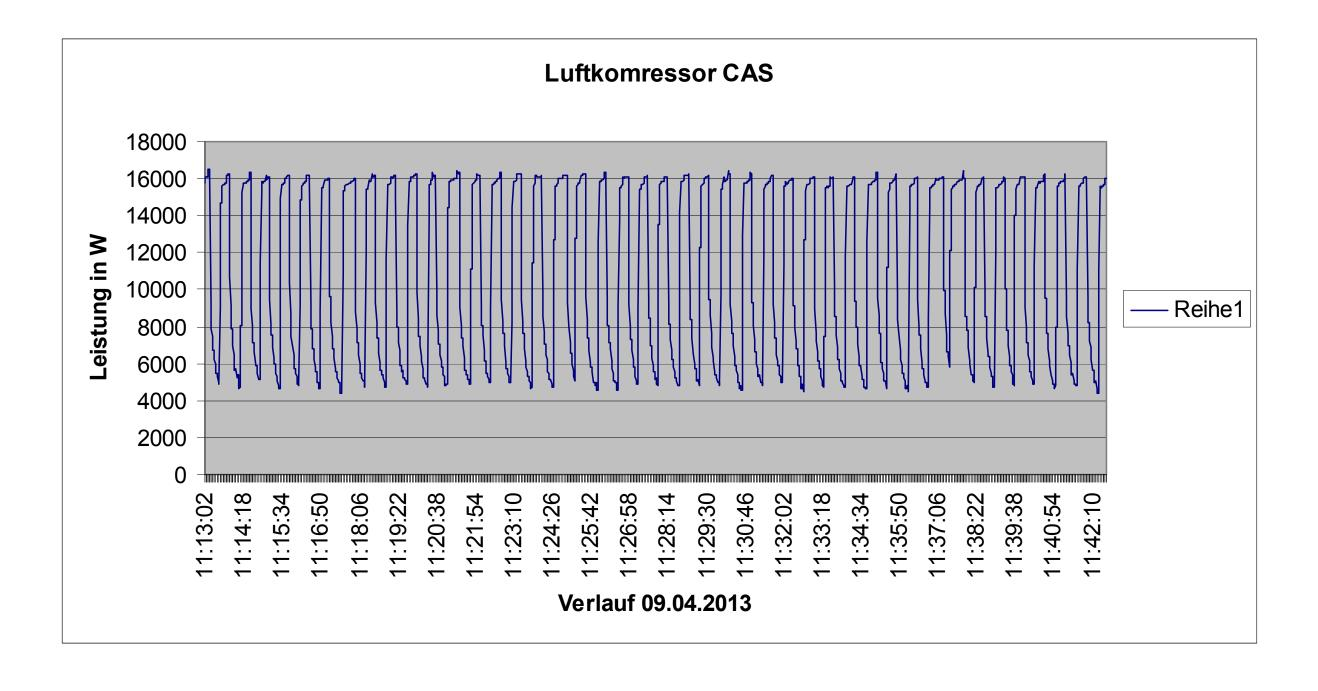
Zusammen entspricht dies ca. 49 % des Gesamtverbrauchs, die sich durch die Neuanschaffung eines angepassten Kompressors einsparen lassen. Die CO<sub>2</sub>-Einsparung beträgt 6,4 t pro Jahr.
