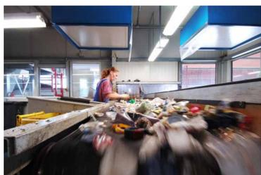
Innerhalb der Hallen werden Aggregate, an denen mit starker Staubentwicklung zu rechnen ist (z. B. Trommelsiebe, Windsichter, Übergabestellen), abgesaugt und die erfasste Abluft über entsprechende Filter gereinigt. Die
